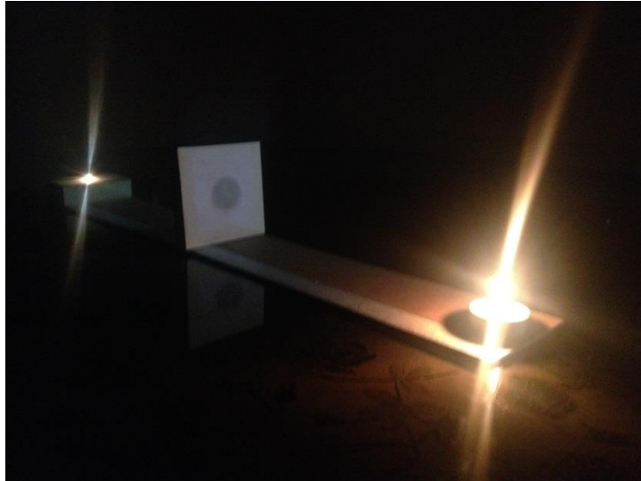
Ilustración 20. Réplica del Fotómetro de Bunsen. Fotografía tomada por Lorena Amaya Jiménez
