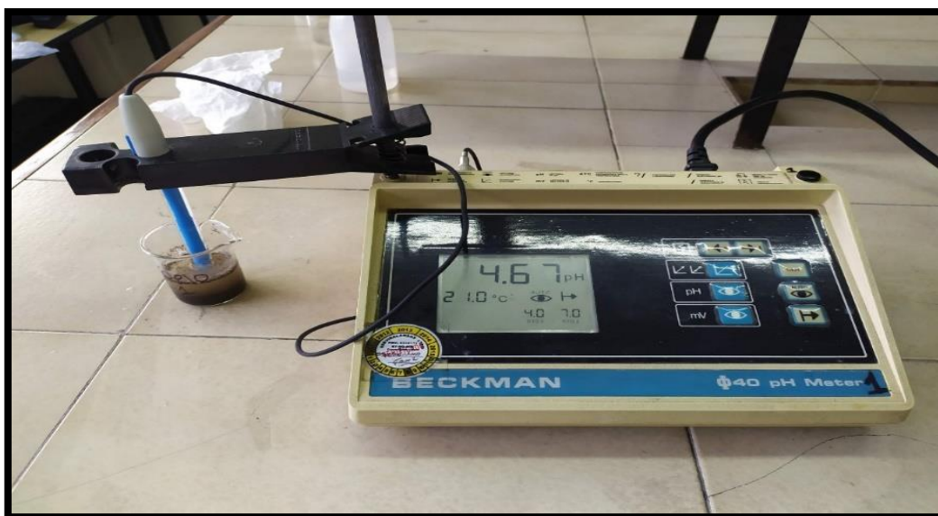
Ilustración 7. Lectura de pH en suelo proveniente del invernadero, relación suelo-agua (1:1).
