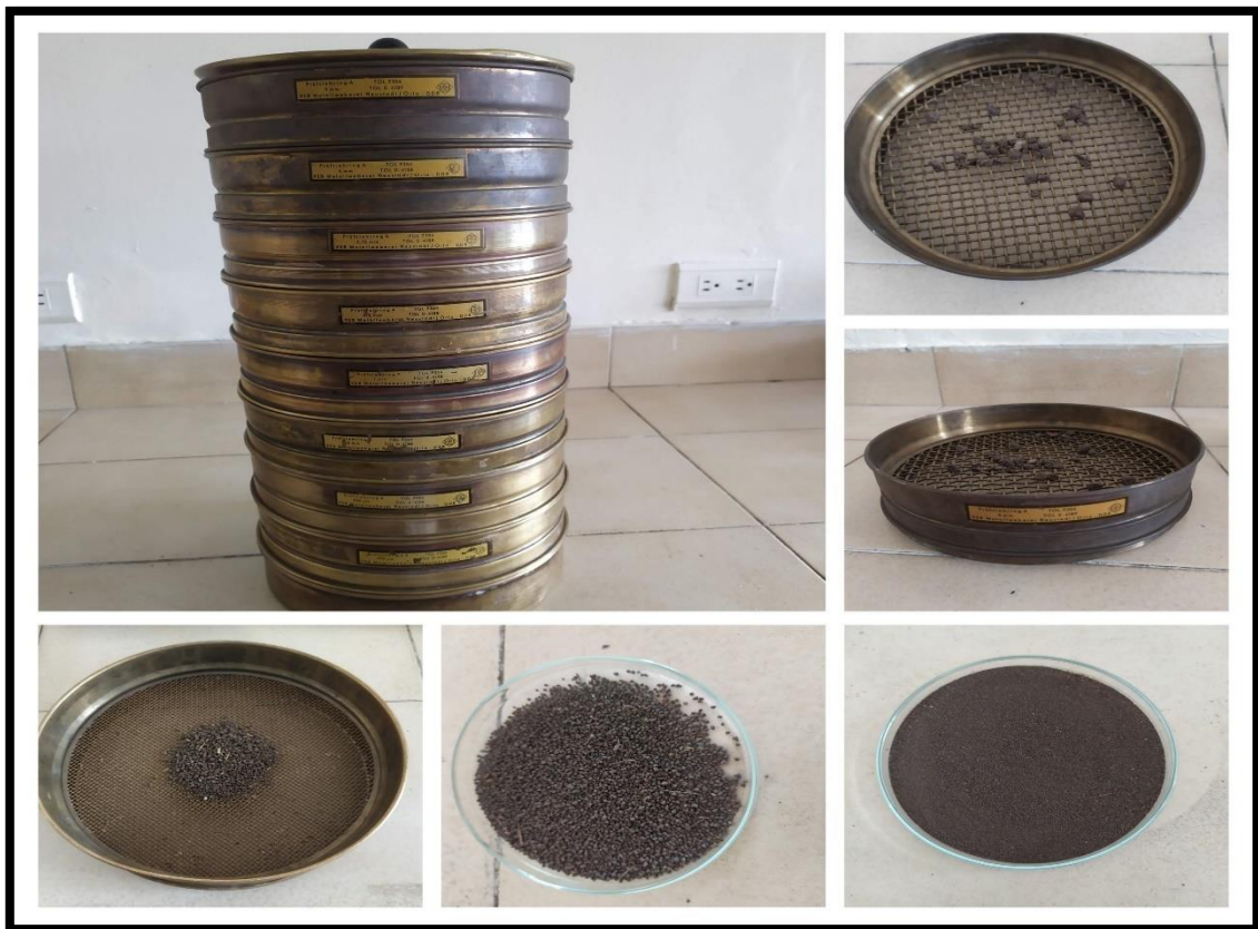
Ilustración 10. Determinación de la textura por el método granulométrico por tamizado.
