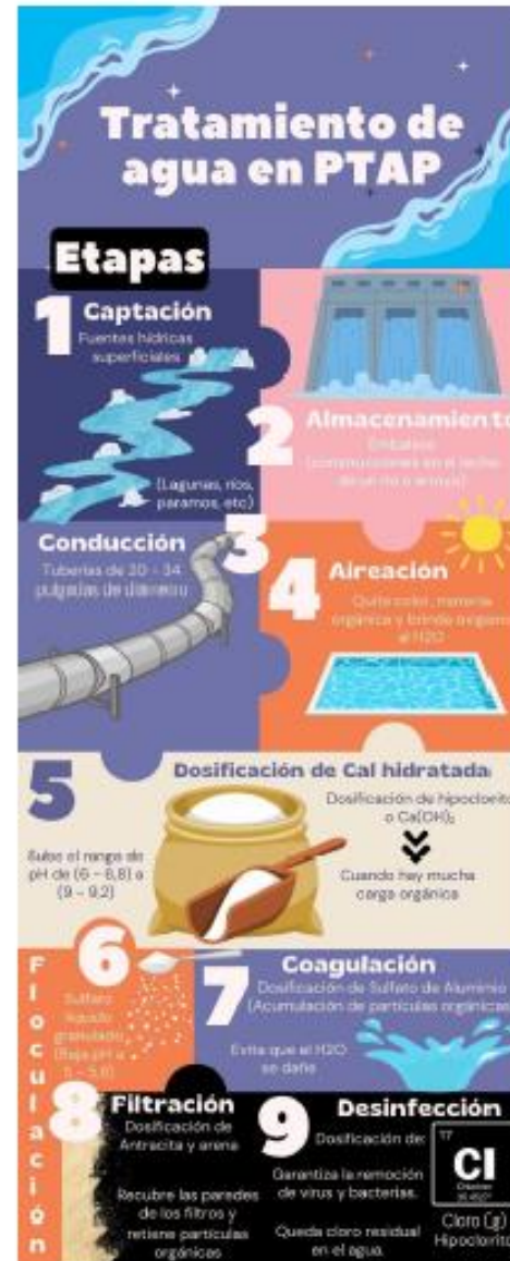
Imagen 1. Infografía etapas tratamiento de agua en la PTAP El Dorado. Información tomada y adaptada de: https://oab.ambientebogota.gov.co/?post
