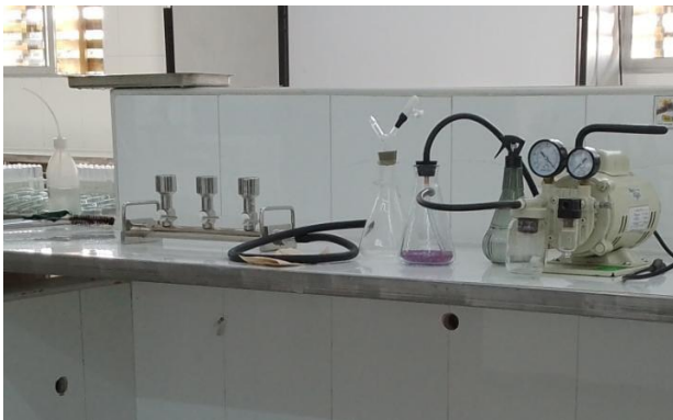
Figura 13. Montaje filtración por membrana
