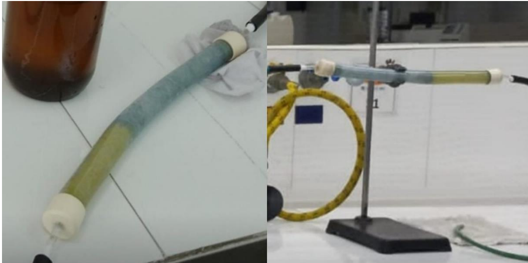
Figura 14. Prototipo de filtro con matriz polimérica soportada en nanopartículas de cobre.
