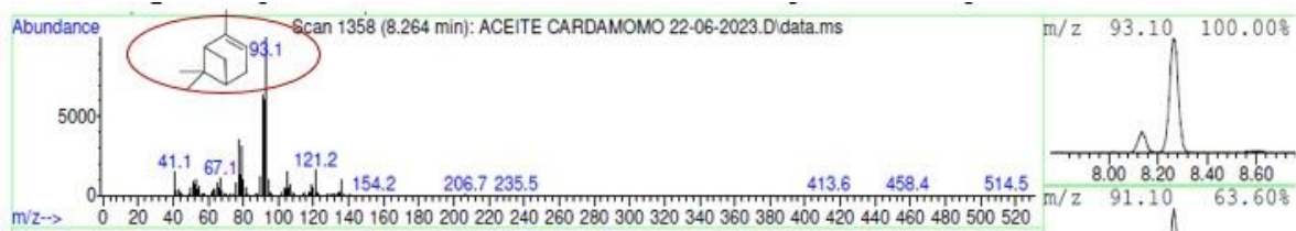
Grafica 15. Caracterización química por cromatografía de gases masas – identificación de \alpha -Pinene.
