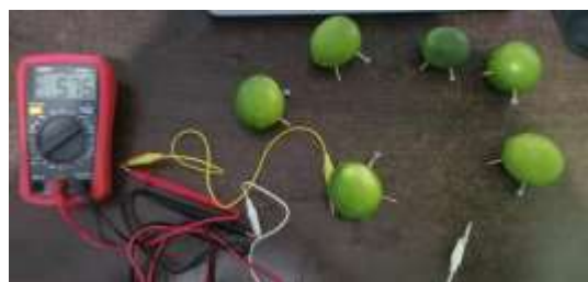
Figura 12. Pila de limones, 0 min, 5,76 V. Autoría propia.
