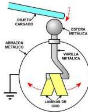
Figura 4. El electroscopio. Sociedad de Estudios Vascos. Tomado de E01.- Fenómenos eléctricos básicos.
