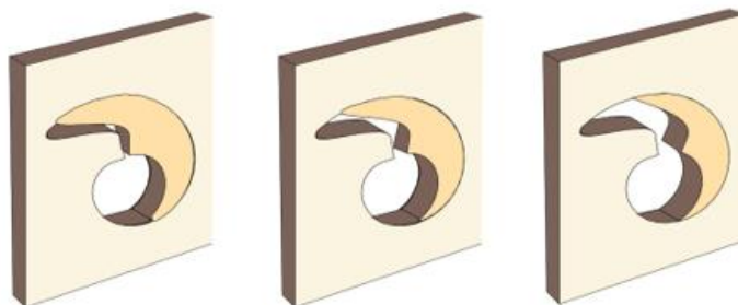
Figura 4-9: Mecanismo kerf – canceling para cortadores laser
