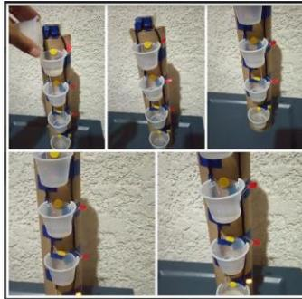
**IMAGEN 31** Montaje 3. Transmisión secuencial de la señal a través de un líquido conductor (agua salada). por Gina Robayo
