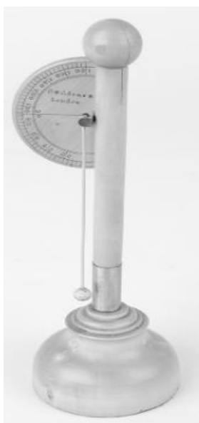
Figura 11. Electrómetro de George Adams
