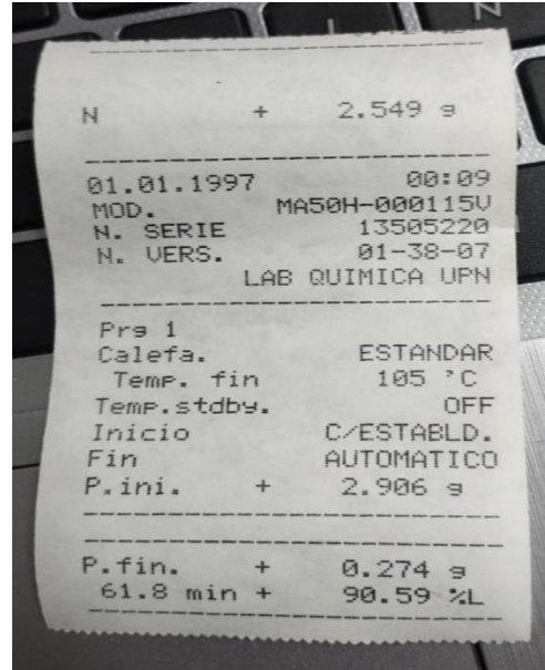
Resultado de humedad medida en termobalanza.
