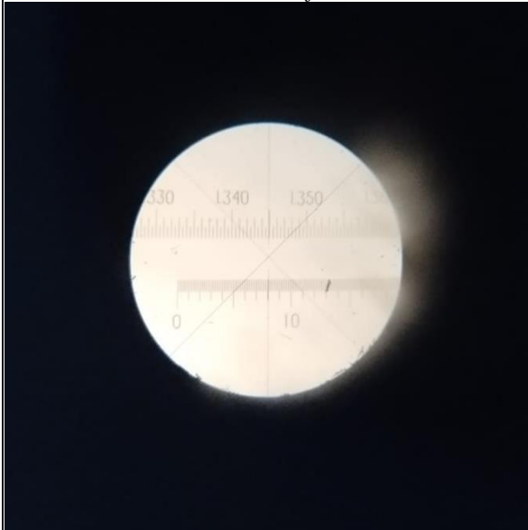
Resultado de índice de refracción muestra.
