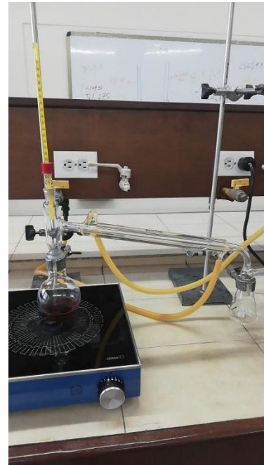
Destilación del solvente para concentrar las antocianinas
