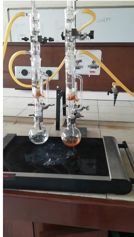
Extracción de antocianina por método Soxhlet.
