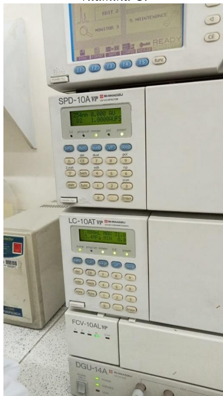
Equipo HPLC que se usó para determinar vitamina C.
