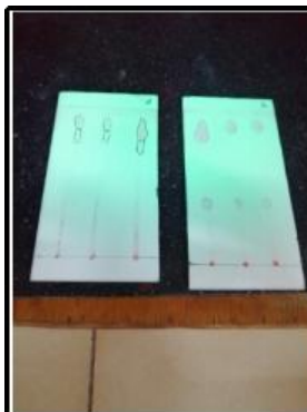
Figura 46. Cromatografía en capa fina, placas A y B. Fuente: Universidad Pedagógica Nacional. 2023.
