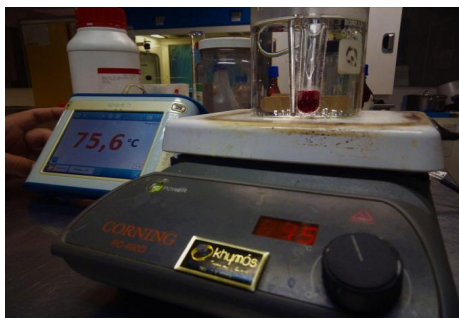
Figura 52. Ensayo Zn+HCL con extracto de Hidrodestilación Asistida por Microondas (HAM). Fuente: TecnoAcademia Cazucá, 2023
