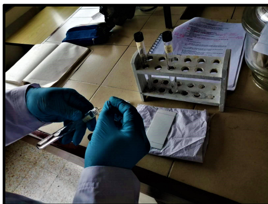
Figura 45. Cromatografía en capa fina, proceso de sembrado. Fuente: Universidad Pedagógica Nacional, 2023.
