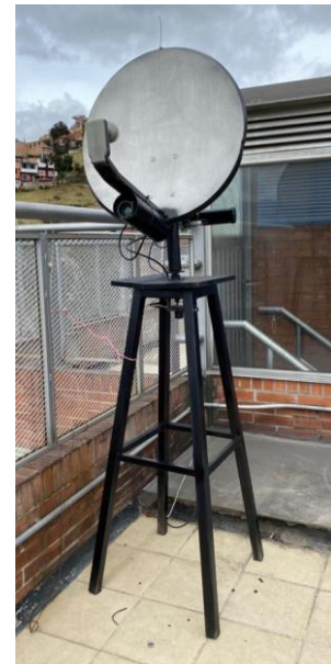
Fotografía 6 Radiotelescopio construido Fuente: Elaboración propia
