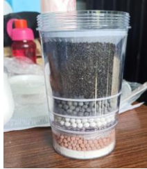
Imagen 11.4, partes del filtro alcalino (construcción), autoría propia. (2022)
