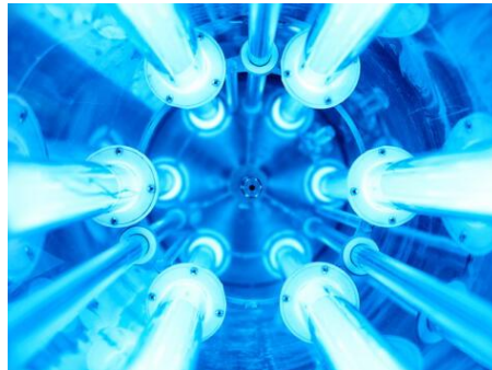
Imagen 1 Vista interna de un purificador de luz ultravioleta, adaptado de Guerrero, R. (2021)
