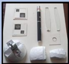
Foto 36. Materiales Difracción por una Placa Zonal de Fresnel
