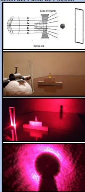
Foto 23. Montaje Experimental y Observación del Punto de Poisson
