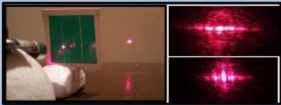
Foto29. Montaje Experimental y Observación Difracción por una Rendija
