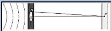
Figura 1. Variación de la intensidad en P debido a la difracción por zonas de Fresnel
