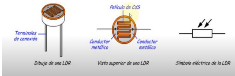
Figura 4: Partes de la fotorresistencia y representación simbólica.
