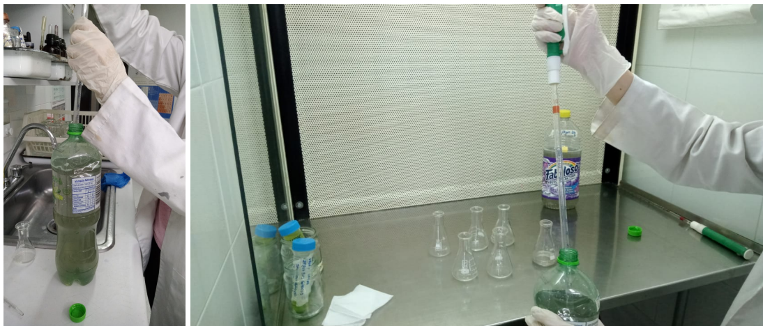
Figura 15. Procedimiento de los bioensayos, en donde se agregaron 45 mL de muestra de agua del Río Tunjuelo y 5 mL de Chlorella Vulgaris en los erlenmeyers.
