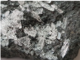
Figura 1. Cristales de sulfato de magnesio
