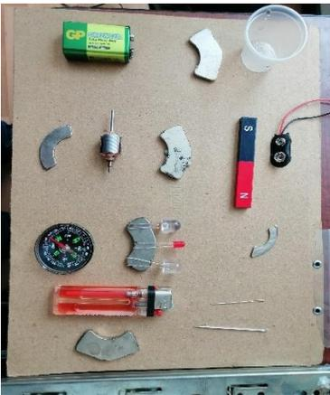
Materiales necesarios para la elaboración de un motor eléctrico, imanes, inducido, soporte y baterías.
