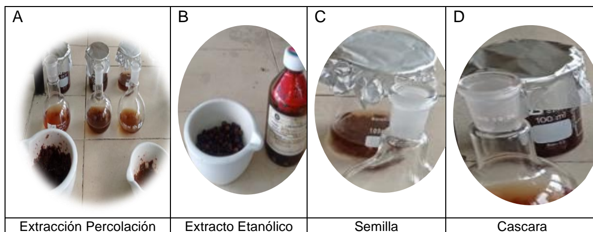
Figura 17: Extracción Por método Percolación (fruto, semilla y cascara) A, Extracto etanólico B, Semilla del producto C, Cascara del producto D.
