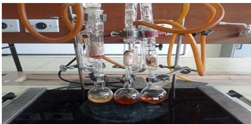
Figura 15: Extracción Por método Soxhlet (zumo, semilla y cascara) del Agraz
