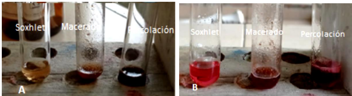
Figura 20: Prueba Shinoda para Flavonoides con la cascara del fruto en (Soxhlet, Macerado y Percolación)
