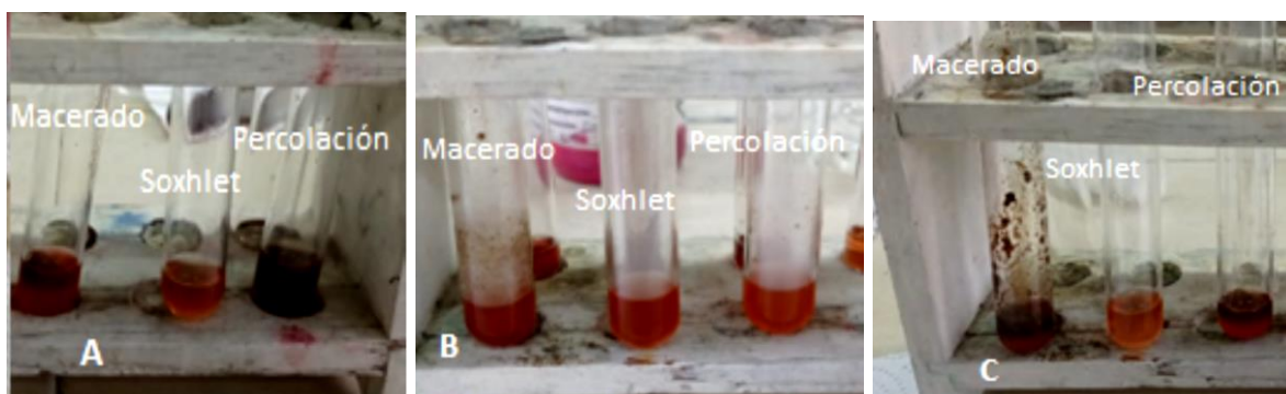
Figura 32: Prueba Hidróxido de Sodio para Cumarinas con extracto, semilla y cascara del fruto en (Soxhlet, Macerado y Percolación)
