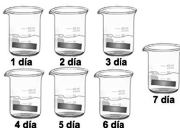
Figura 2.1. Montaje para la oxidación de placas metálicas
