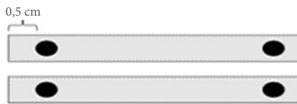
Figura 3.5a. Construcción del soporte de la pila
