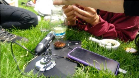
**Ilustración 14**, Campilógrafo enfocado en muestra de agua con *Lemna minor*
