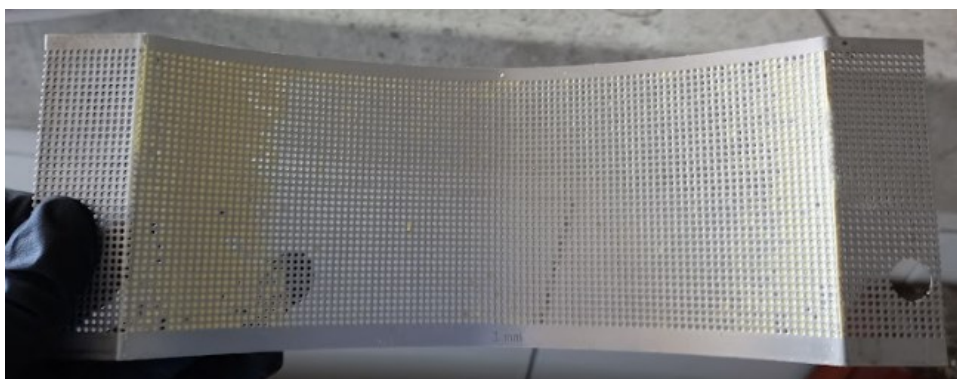
Foto 8: Malla con tamaño de partícula 1mm, para molino Thomas Wiley modelo 4. Fuente: Autoras.
