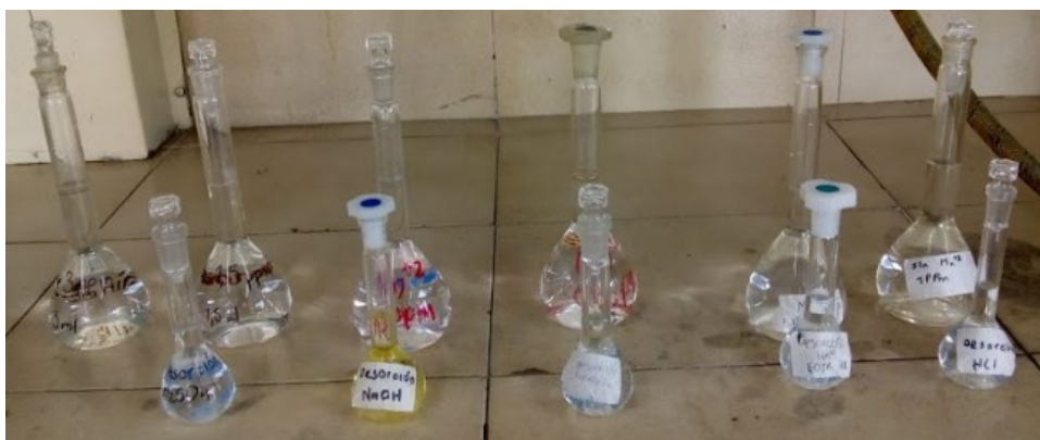
Foto 35: Soluciones extractoras HCl, H 2 SO 4 , EDTA, NaOH y Ca(NO 3 ) 2 y soluciones Patrón 0,25, 0,5, 1, 1,5, 2 y 3 ppm preparadas por los estudiantes. Fuente: Autoras
