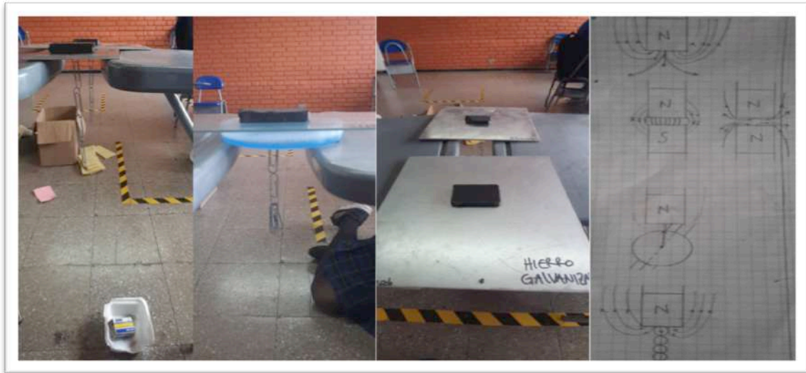
Imagen 120 Montaje experimental para determinar los comportamientos de las fuerzas magnéticas al interponer diferentes medios físicos y su representación.
