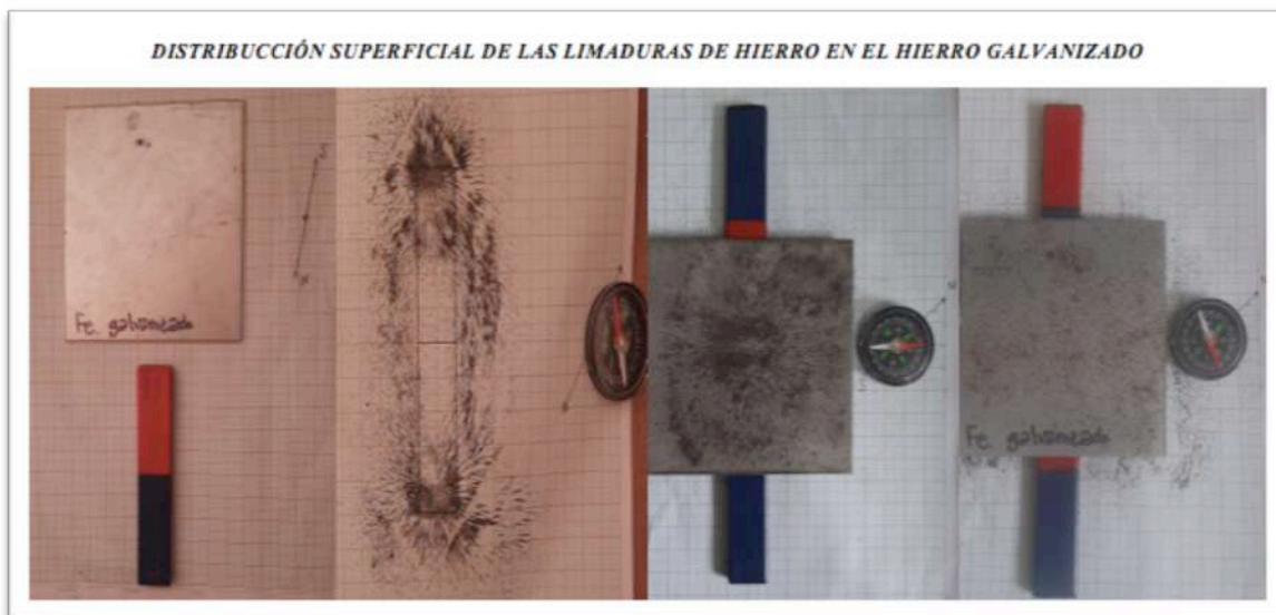
Imagen 54 Distribución superficial de los efectos magnéticos en el medio físico del hierro Galvanizado. Autoría del docente investigador.
