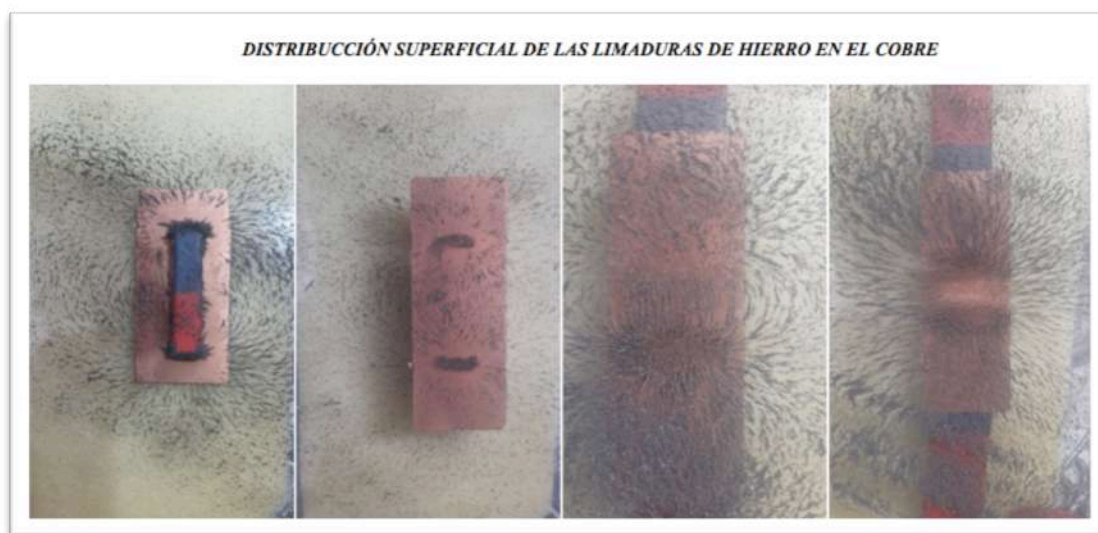
Imagen 51 Distribución superficial de los efectos magnéticos en el medio físico del cobre. Autoría del docente investigador.
