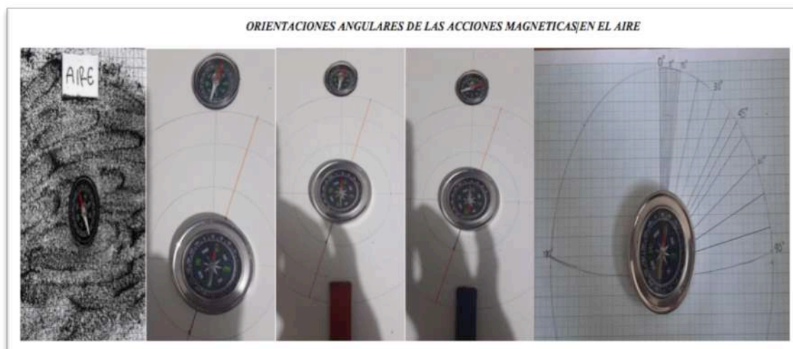
Imagen 45 Relación de la permeabilidad magnética del aire con los cambios de la dirección de la aguja magnética en diferentes brújulas. Autoría del docente investigador.
