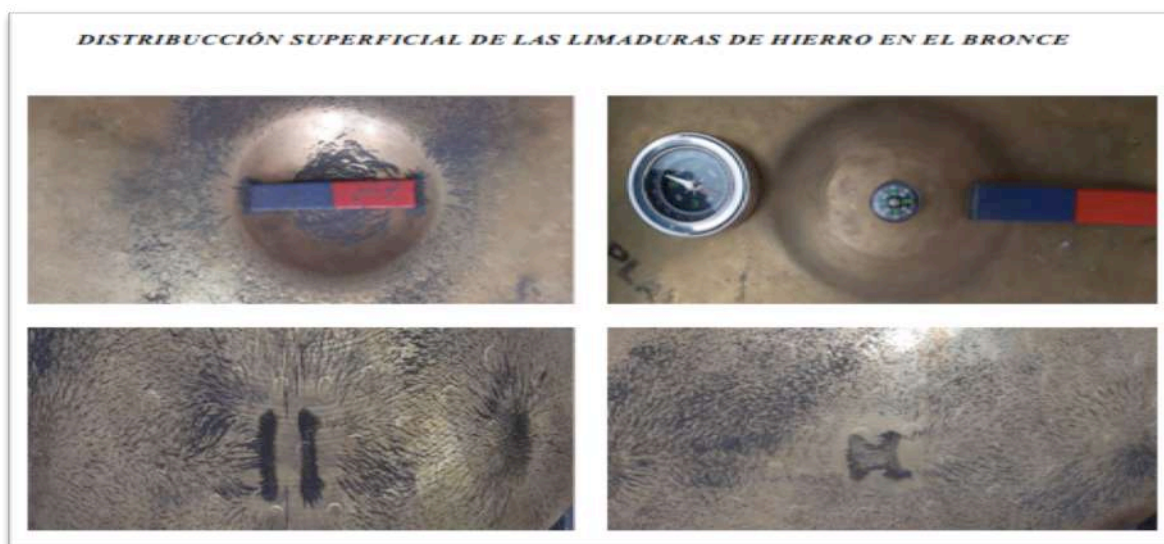
Imagen 52 Distribución superficial de los efectos magnéticos en el medio físico del acero. Autoría del docente investigador.
