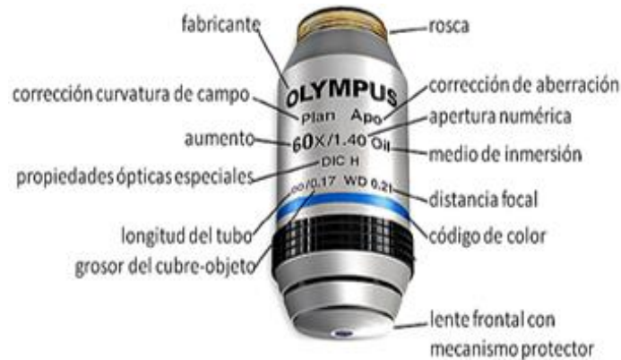
Ilustración 11. Propiedades de un objetivo en el microscopio.
