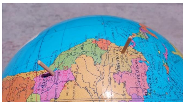
Fig. 57 Colocación de dos estiletes en diferentes locaciones de un globo terráqueo. Se procura que un gnomon no tenga sombra (der) mientras se observa el gnomon ubicado en otra parte, y viceversa. Fuente: elaboración propia.
