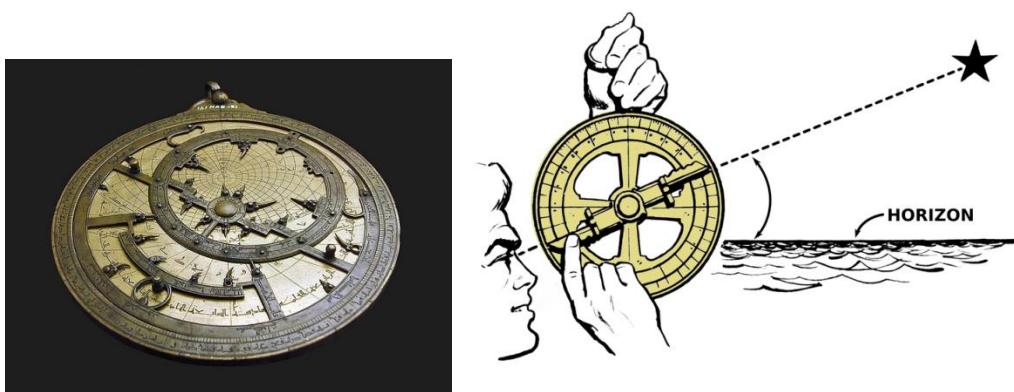
Fig. 23: Astrolabio plano. Izq.: Astrolabio. Der.: forma de uso para obtener altitud angular del astro observado. Fuente: Culturacientifica.com. 2015 (izq.); Pearson Scott Foresman, 2015 (der).
