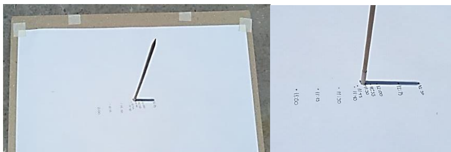
Fig. 49 Gnomon. Izq. Detalle general. Der: detalle del registro del extremo de la sombra. Los datos registrados corresponden a la hora local. Fuente: elaboración propia.
