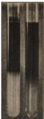
Ilustración 5. Difusión de un coloide y de una disolución en gelatina al 5%, propiedad presentada por Graham y por Oswald para explicar la difusibilidad de las sustancias.
