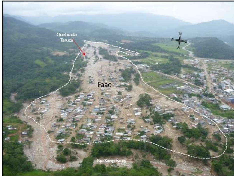
Ilustración 3 Panorámica del abanico fluviotorrencial formado por la avalancha del 31 de marzo y 1 de abril del 2017, Fuente: Paredes, O. E., Calvache, M. L., & Ruiz, G. L. (2018). Ruiz, G. L., & Merchán Reyes, A. (2018). Evaluación de la Amenaza por movimiento.
