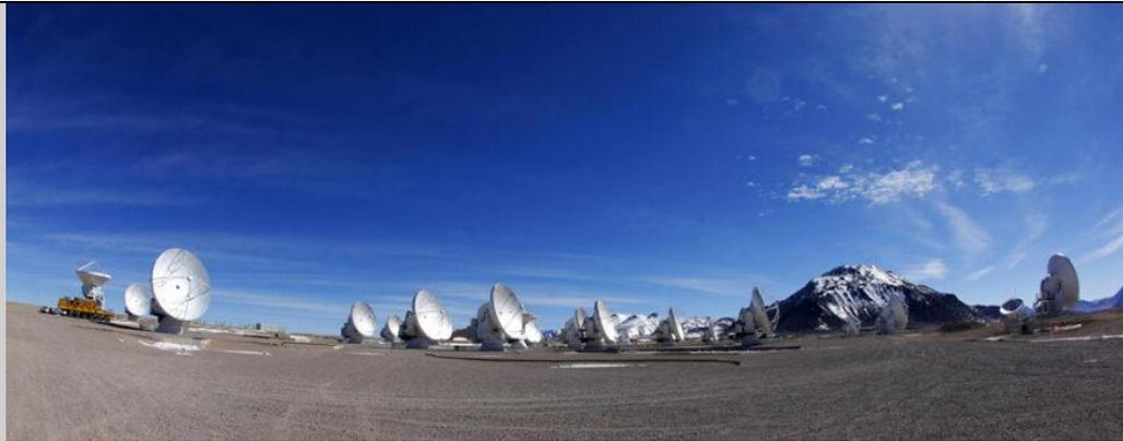
Las 66 antenas de ALMA funcionan juntas como si fueran un solo telescopio gigante. Para ello utilizan una técnica denominada interferometría. Esta consiste en recolectar una señal proveniente del Universo usando dos o más antenas y combinarlas para analizar la señal y así obtener información sobre la fuente de tal emisión (ya sea una estrella, planeta o galaxia).
