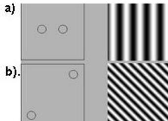
*Imagen 15. Relación entre la posición de las antenas (izquierda) y el patrón de interferencia que se recibe (derecha). Imagen tomada de: <https://mural.uv.es/imarvi/Interf/Interf.html> sección 1.2.*
