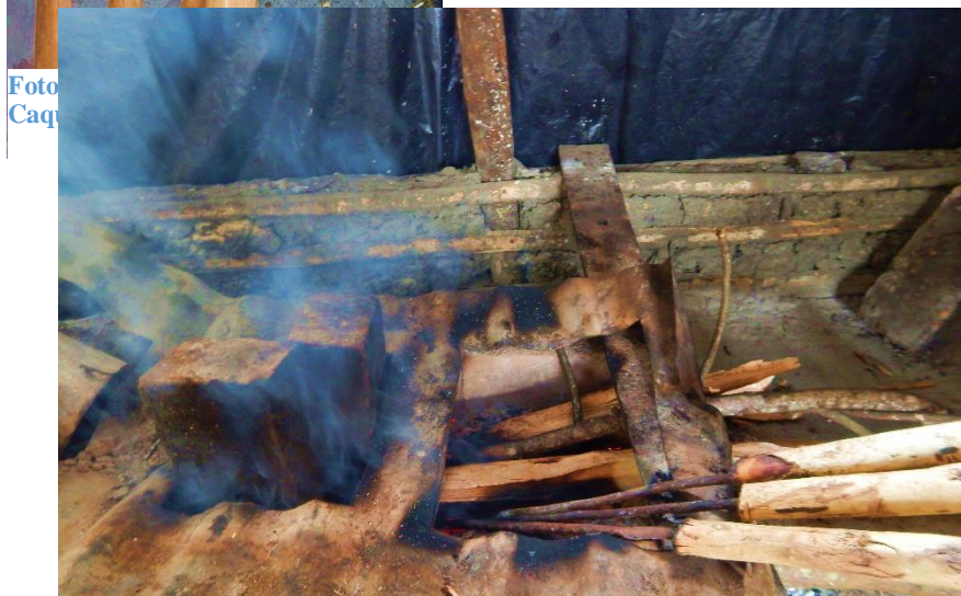
Foto 27: Varillas calentándose para poder ahuecar las flautas, Caquiona. Guiselle González, Julio 2018.
