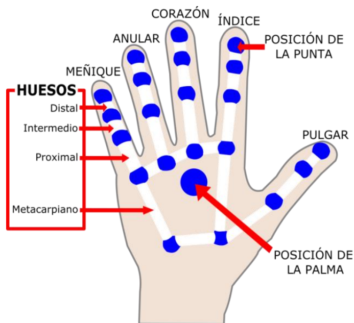
Figura 5. Representación gráfica de la mano derecha en Unity con ayuda del SDK “Orion”. Fuente: Adaptado de www.leapmotion.com
