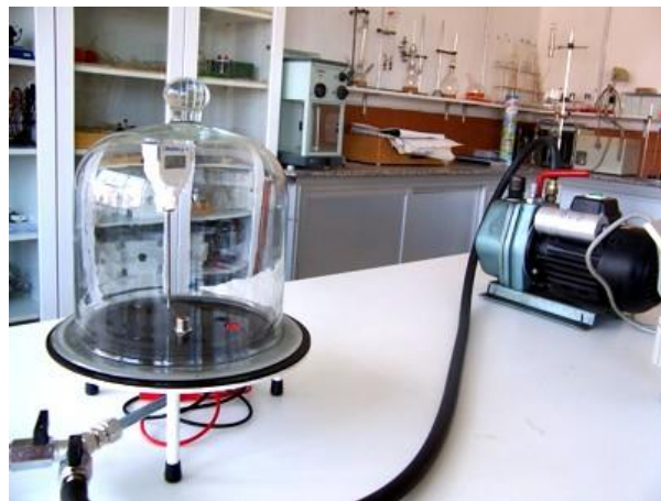
Imagen 1: Campana de vacío, instrumento de laboratorio usado para crear vacío, en busca de, entre otras cosas, observar cómo actúa la materia ante cambios drásticos de presión
