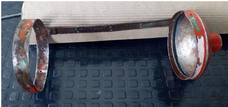
Figura 8 Prototipo de extintor después de los cortes a su estructura metálica. Fuente: propia.
