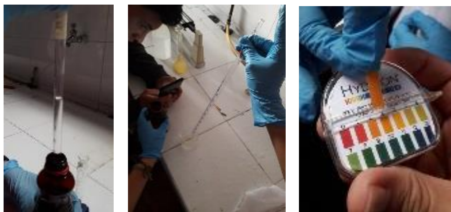
Imágenes 13 y 14. Adición de HCl a la solución de Amoniaco. Determinación del pH con papel indicador.
